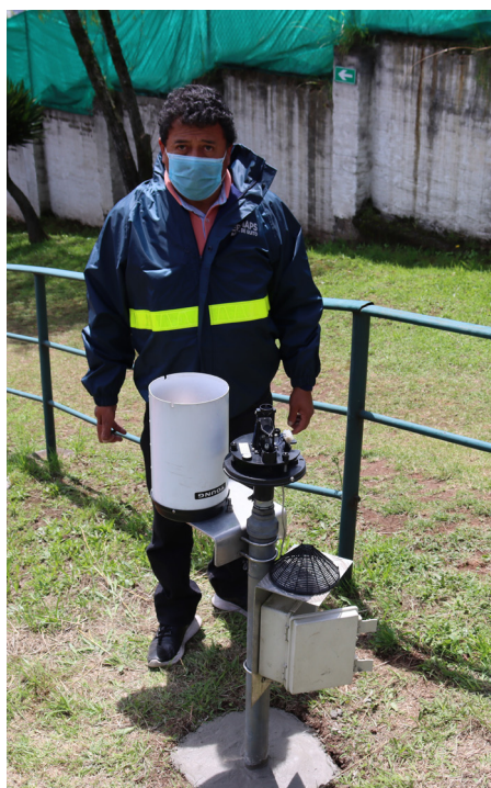
El pluviómetro es un instrumento que se emplea en las estaciones meteorológicas para la recogida y medición de la precipitación.
